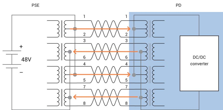
Figure 3 : Schéma de principe du PoE
