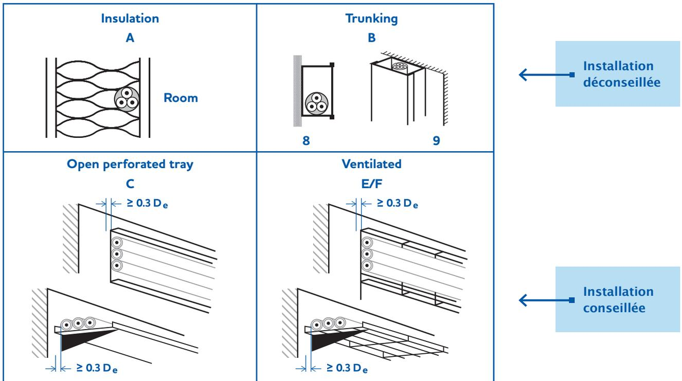
Figure 7 : Illustrations de différents environnements d'installation (ventilé, isolé)
