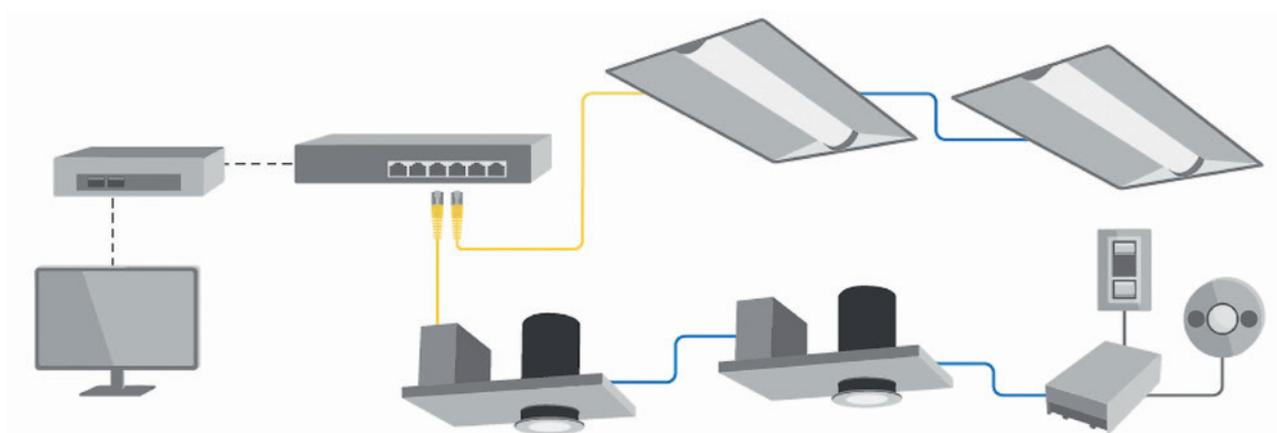
Figure 10 : Un exemple d'architecture d'éclairage en PoE.
