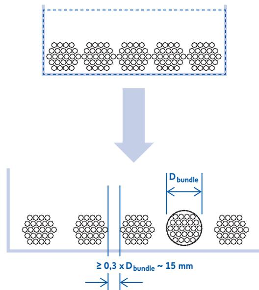
Figure 6 : Règles d'espacement des faisceaux de câbles
